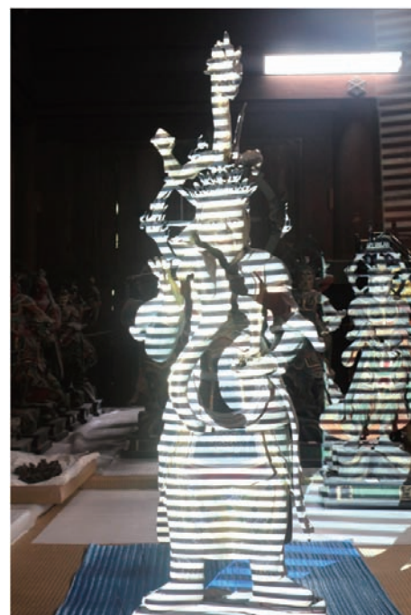
fig1. マルチスリットパターン投影画像
